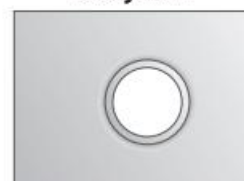
Прессование - фланцевое отверстие
